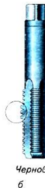
Рис. 81. Метчики: а — основные элементы; б — комплект для нарезания метрической резьбы
