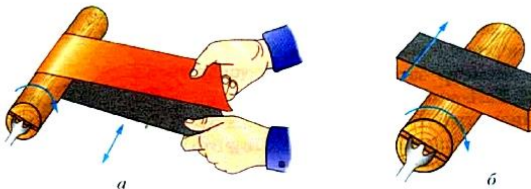
Рис. 31. Шлифование детали: а — шкуркой; б — шлифовальной колодкой
