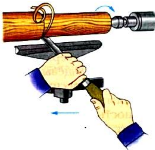
Рис. 28. Черновое точение заготовки на токарном станке
