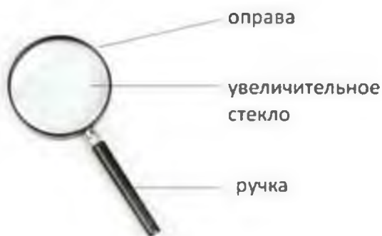
Рис. 1. Строение ручной лупы
